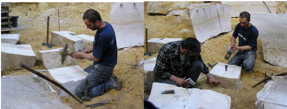
Fig. 3.72: Carrière de Moigny sur Ecole: le dédoubleage des blocs (Document Jean Pillot, AFF)
