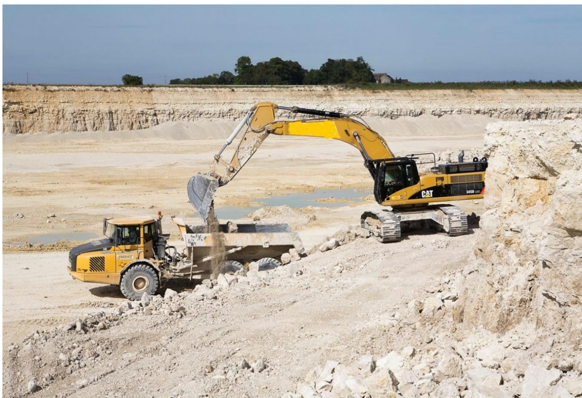
Fig. 7.20 : Carrière de calcaire de Souppes sur Loing : au 1 er plan chargement d'un tombereau, au fond : fronts de la carrière (Document de la Société des Carrières de Souppes sur Loing)
