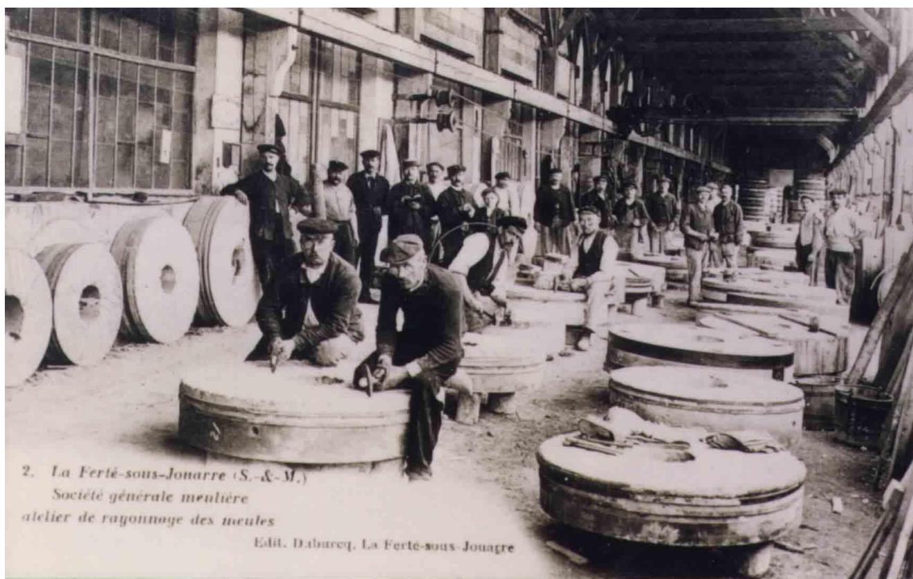
Fig. 9.16 : Vue de l'atelier de finissage de meules (tracé de rayons à leur surface)- Sté Générale Meulière (Document du Syndicat d'initiative de La Ferté sous Jouarre)
