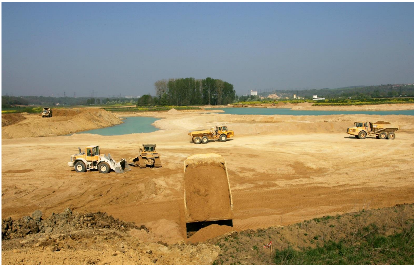
Fig. 7.6 : Carrière de Varenne-sur- Seine et Ville-St-Jacques : opération de découverte pour rendre accessible le gisement de granulats alluvionnaires (zone de circulation des engins) et vue sur la nappe d'eau (au second plan). (Document GSM)
