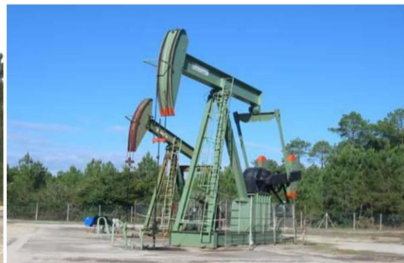
Fig. 10.21 : la mise en production des puits d'exploitation par des pompes (Données de la Sté Vermilion REP, 2013)
