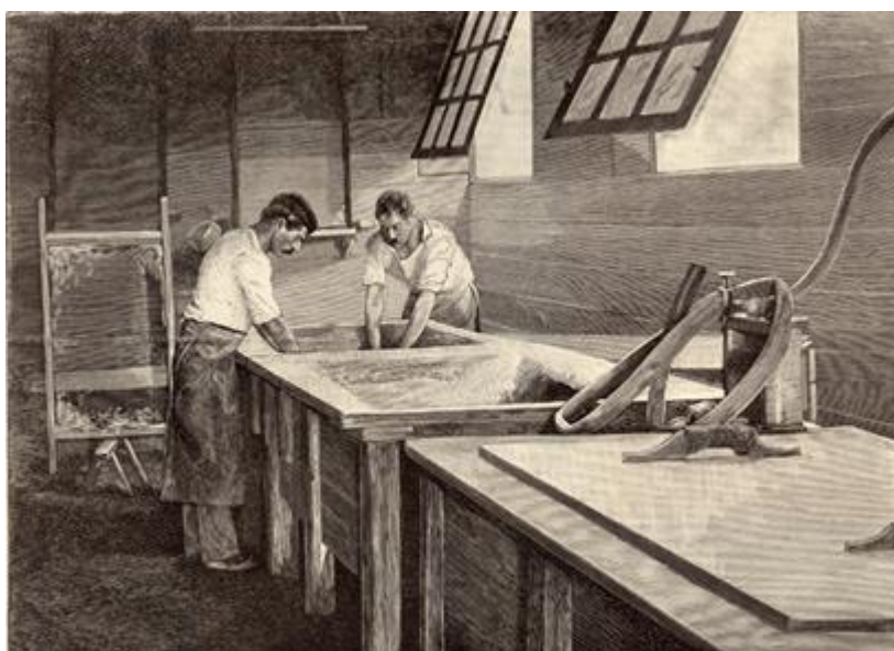
Pétrissage de la dynamite, dynamiterie de Paulilles (Pyrénées Orientales) Document www.aphpo.fr
