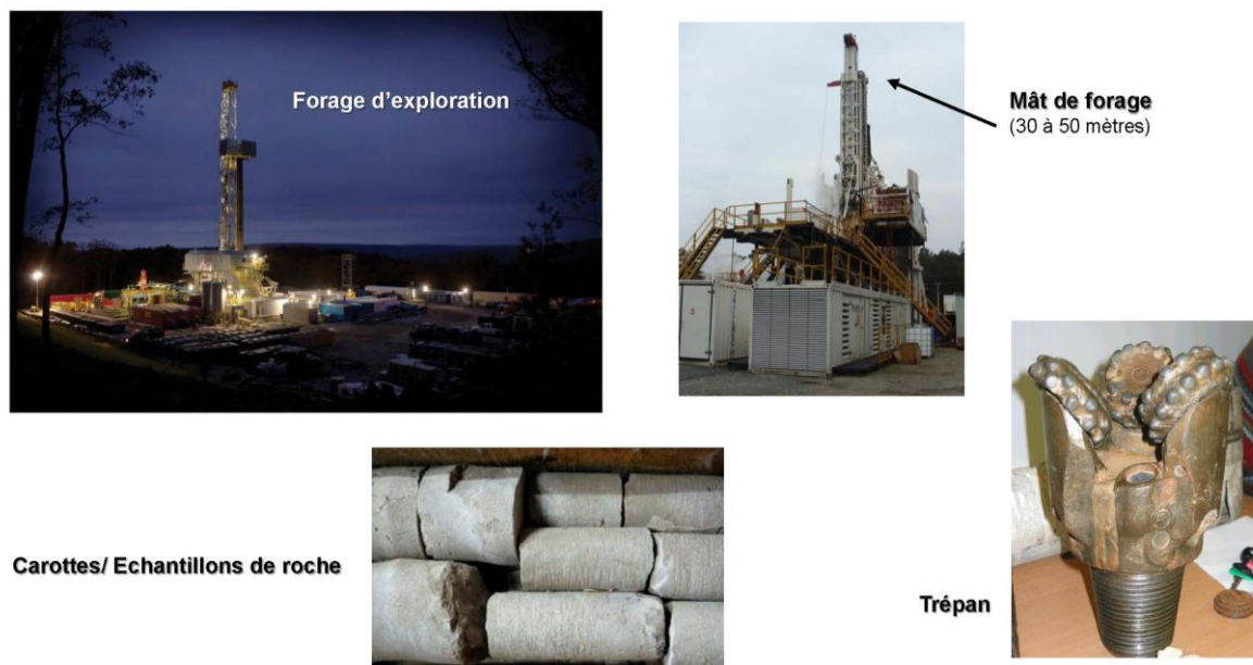
Fig. 10.19 : le forage d'un puits de reconnaissance du gisement (données de la Sté Vermilion REP, 2013)
