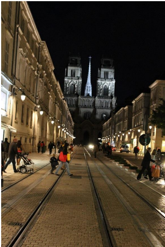
Fig. 5.33: pavage de voie du tramway à Orléans et réalisation de trottoirs en pierre de Souppes (Document SCSL, 2013)
