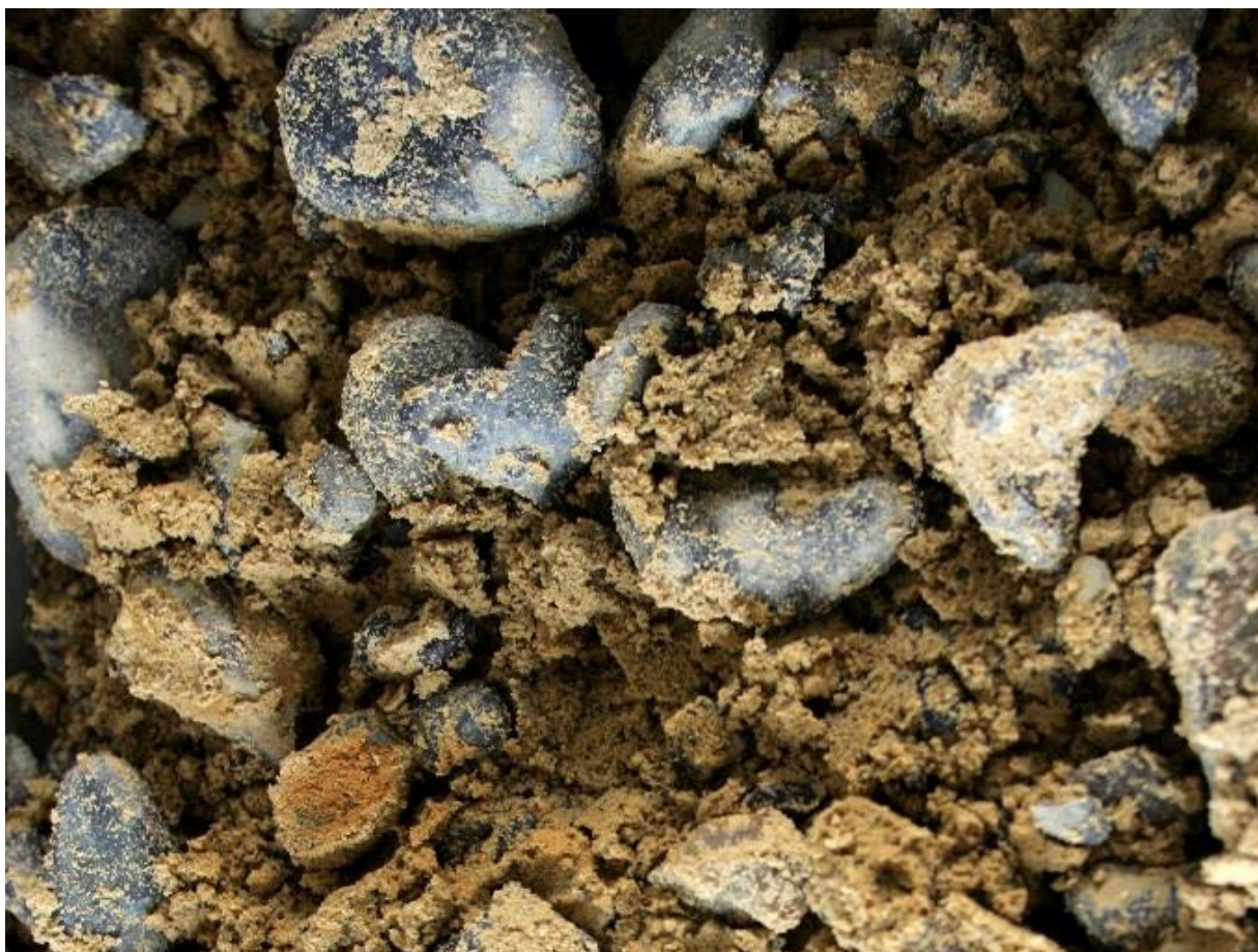
Fig. 7. 13 : Blocs de chailles dans matrice sablo-argileuse, après lavage (Document GSM)
