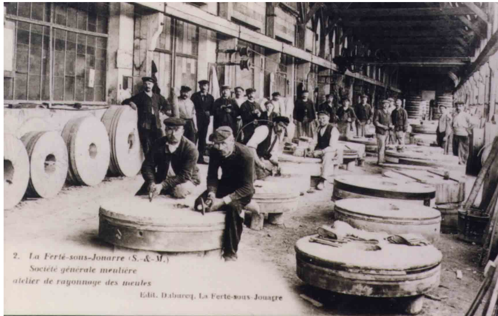
Fig 9.15: Vue de l'atelier de finissage de meules (tracé de rayons à leur surface)- Sté Générale Meulière (Document du Syndicat d'initiative de La Ferté sous Jouarre)
