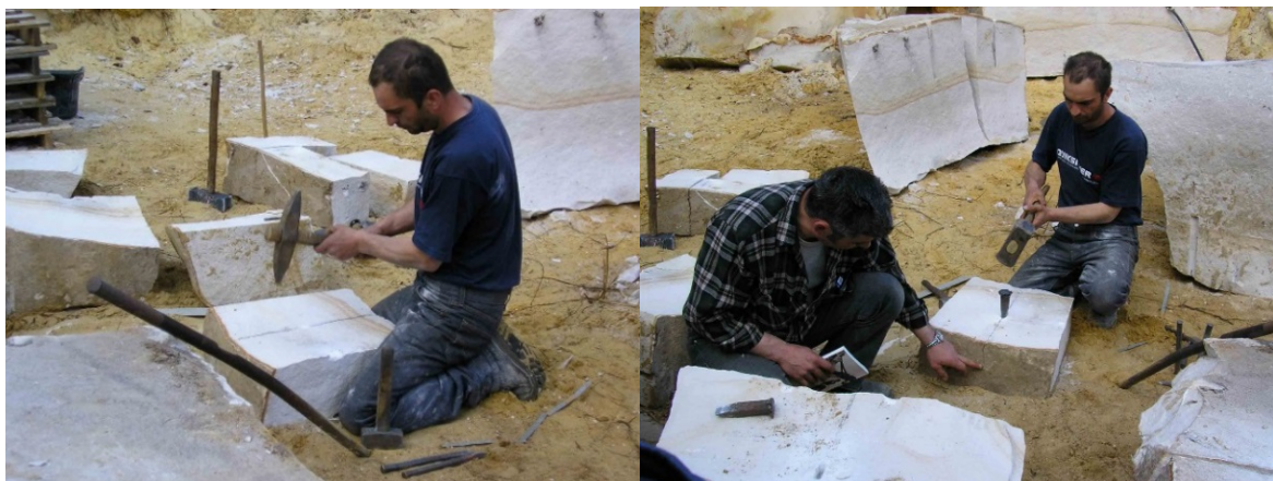
Fig 3.36 : Carrière de Moigny sur Ecole: le dédoubleage des blocs
