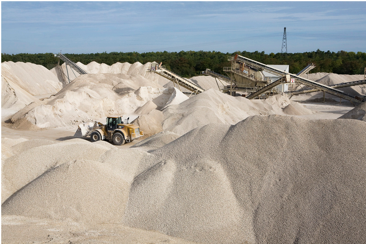
Installation de traitement et de stockage des granulats calcaires (Document SCSL)
