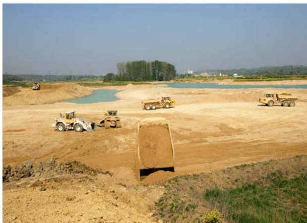
Carrière de la Varenne sur seine : opération de découverte et vue de la nappe d'eau au niveau du gisement de granulats alluvionnaires
