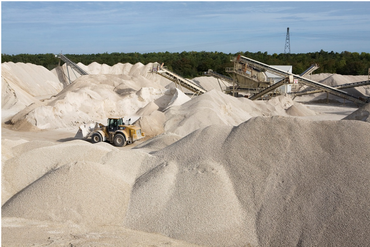
Fig 6.71 : Installation de traitement et de stockage des granulats (Document SCSL, 2013)
